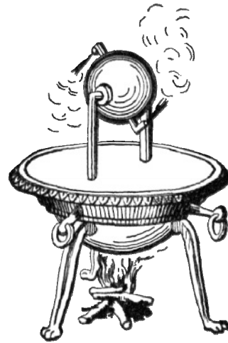
アイオロスの球 蒸気を噴出しながら、くると回転する。
